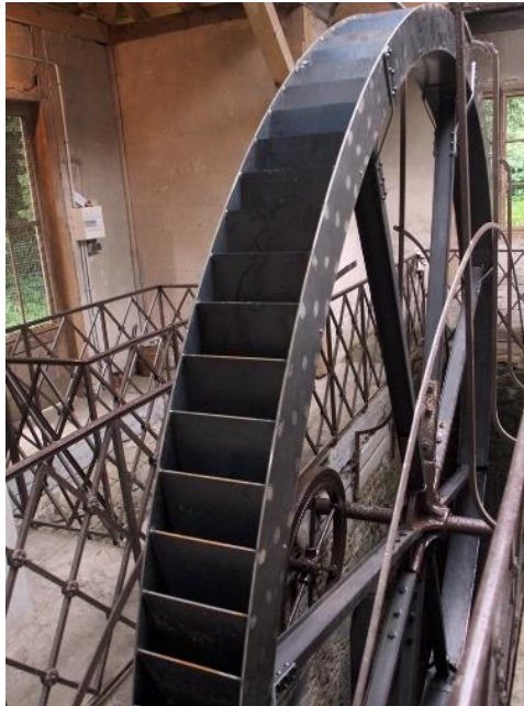
Roue à augets de Notre-Dame du Grand-Port. D.R. Mairie de Collonges au Mont d'Or
